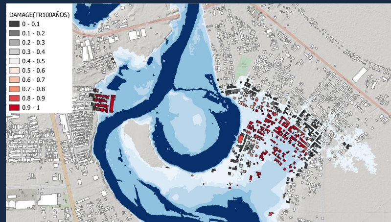
Daños por inundación en Colonia Carrillo y Jardines del Río para un periodo de retorno de 100 años.
